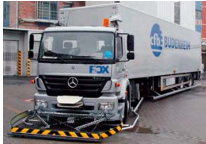
Fahrerlose Transportfahrzeuge gehören in vielen Betrieben zum Alltag. Spurführungssysteme sorgen dafür, dass alles in geordneten Bahnen läuft Bilder: Götting
