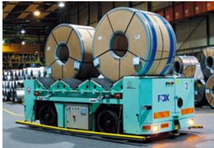
LKW lassen sich über im Boden verlegte Transponder ohne Fahrer über das Werksgelände steuern. Wenn sich in der vordefinierten Spur ein Hindernis befindet, wird das Fahrzeug automatisch gebremst
