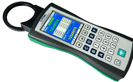
Variante HG G-81840YA grüne Dekordichtung, 13,56 MHz
