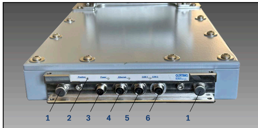
Bild 5 Transponder-Antenne HG G-98870-A (im Bild Variante HG G-98870ZA)
