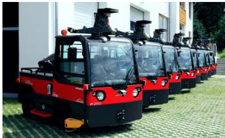
Automatisierte Elektroschlepper mit automatischem An- und Abkuppeln von Anhängern
