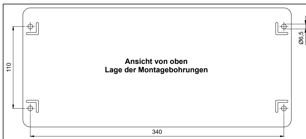
Bild 5 Lage der Montagebohrungen der Antenne
