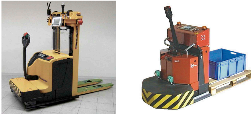
Bild 1 Beispiele für Fahrerlose Fahrzeuge mit Transpondern
