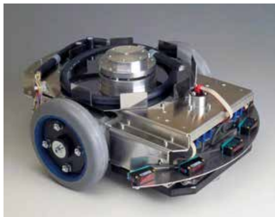
Das Fahrenkmodul HG G-08230YA FLM01 ist das Herzstück der KATE-Fahrzeuge
